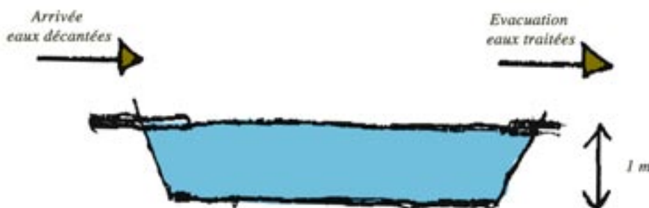
Schéma d'une lagune d'eau libre.
